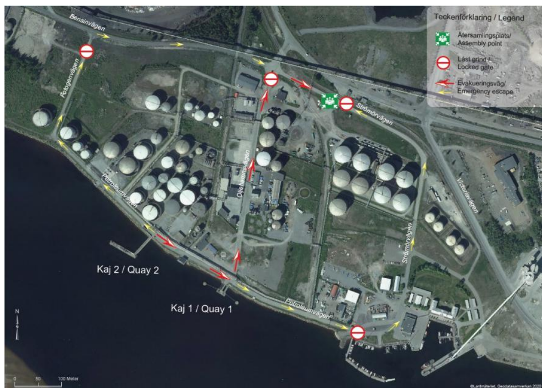
Figur 2. Huvudutrymningsväg - röda pilar. Sekundär utrymningsväg - gula pilar.
