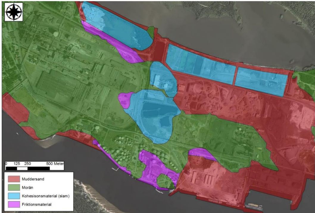
Figur 5-4 Översiktlig bild som visar naturliga och konstgjorda geologiska förutsättningar. Grönt område består av naturlig morän och visar den ursprungliga kustlinjen år 1944. Rött/rosa visar områden som fyllts ut med i huvudsak osorterad muddersand. Lila visar områden som fyllts ut med friktionsmaterial (sten, grus, slagg) för ökad bärighet. (Bildkälla: SSAB Luleå, Statusrapport 2016-03-02).
